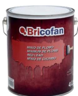
ES Imprimación sintética a base de resinas alquídicas y minio de plomo. Especial para proteger superficies metálicas en exteriores. Gran resistencia a los agentes atmosféricos y su elevado poder antioxidante. Secado al tacto entre 30 y 60 minutos, para segundas manos 24 horas. Rendimiento: de 7 a 11 m<sup>2</sup> por litro y mano, dependiente del material.
