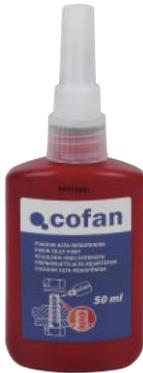
**ES PROPIEDADES:** Especial para uniones de solicitud elevada. Desmontable aplicando calor (300°C). No necesita activadores para su curado. No crea problemas de fijación. Fija y sella tuercas, tornillos, espárragos, etc.
