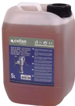
ES Aceite corte emulsionable para materiales ferrosos y no ferrosos como el aluminio o aleaciones. Es posible diluirlo al 5% y protege de la corrosión tanto en piezas elaboradas como las máquinas y herramientas.
